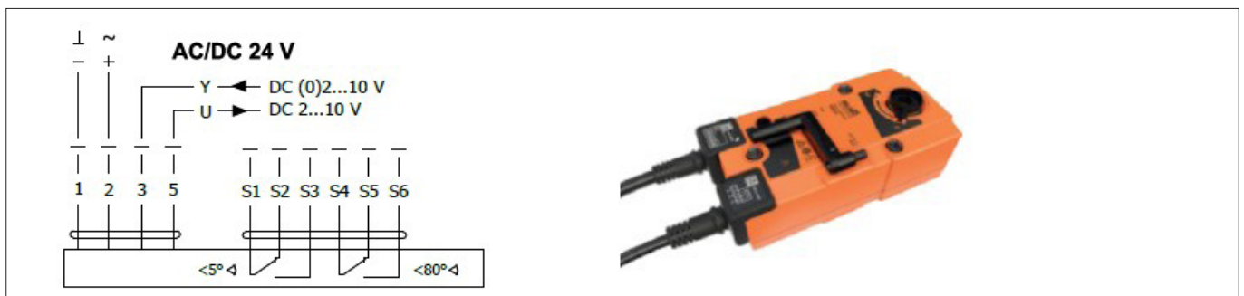
Fig. 4 Actuator BELIMO BEN 24-SR
